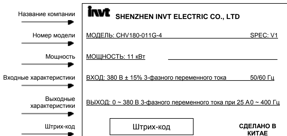
Рисунок 1.1 Паспортная табличка преобразователя частоты
