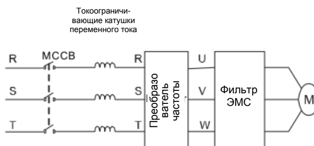
Рисунок 4.8 Электромонтаж цепи электродвигателя
