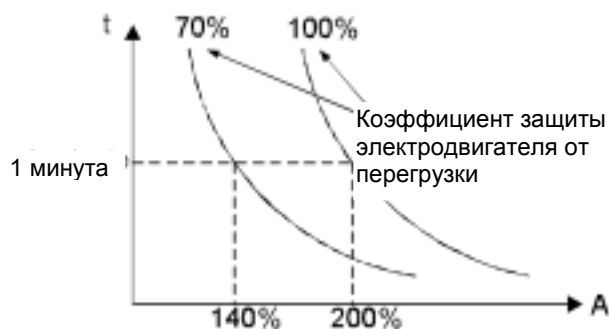
Рисунок 6.16 Кривая защиты электродвигателя от перегрузки
