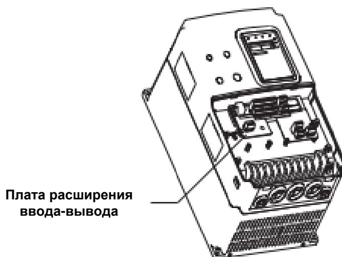
Рисунок 7.6 Монтаж платы расширения ввода-вывода и платы генерации импульсов
